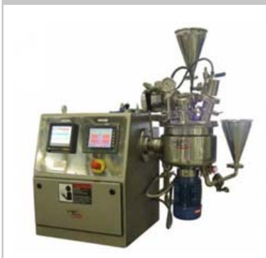
Reactor- emulsionador BI-AGI 5. Equipo ideal para realizar emulsiones a partir de 2 litros y hasta 5 litros, con la posibilidad de realizar vacío y presión interior y calentamiento y refrigeración de la emulsión. [clicar para mayor resolución]
