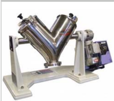
Mezclador en "V" de laboratorio Mod. B-8-CAI para la mezcla intensiva de sólidos con la posibilidad de realizar inyección de líquidos [clicar para mayor resolución]
